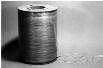
Стеклотенту главным образом применяют для бандажирования роторов электромашин. Бандажированный элемент лентой TSE-200 упрочняется в температуре 130+140 °C в течение 25+30 минут, а затем упрочняется в температуре 130 °C в течение 24 часов, 140 °C в течение 12 часов или 150 °C в течение 6 часов. Изоляцию можно механически отделявать (точить, фрезеровать) употребляя вентиляционный отсос.
