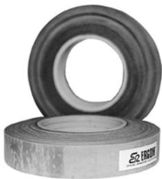
Электроизоляционные лакотканы и стеклотенты и полиэфирные ленты являются электроизоляционными материалами получаемыми путем пропитки фталевикарбамидным лаком стекланный ткани (TsK) или полиэфирной ткани (ТПК). Их применяют в качестве низковольтной и средневольтной изоляции электромашин и электрооборудования, а также в качестве изоляции концов и соединений проводов и кабелей.
