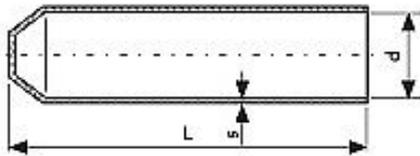
Их применяют для уплотнения и защиты силовых кабелей и кабелей связи с металлическими и пластмассовыми покрытиями.
